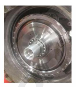
CAUTION - BE GENTLE WHILE ASSEMBLING THE CLUTCH AS THE OIL PUMP GEAR LUGS CAN BREAK.
